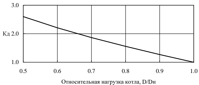
Рисунок Е1 – Зависимость K_d от относительной нагрузки котла
