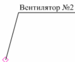
Рисунок 42. Выноска с «полочкой» для точечного источника шума «Вентилятор №2»
